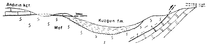
Şekil 6: Şariyaj cephesi arkasında molas çukurunun yaklaşık yerini gösterir taslak kesit
